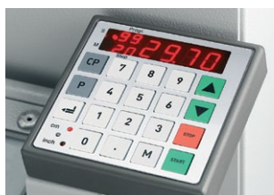
Módulo de control programable "EP" de la escuadra trasera con lectura digital de medidas y teclado de 10 botones para preseleccionar las medidas.
