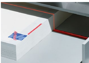
La línea óptica de corte indica donde se efectuará el corte y permite alinear las marcas con precisión para un corte exacto.
