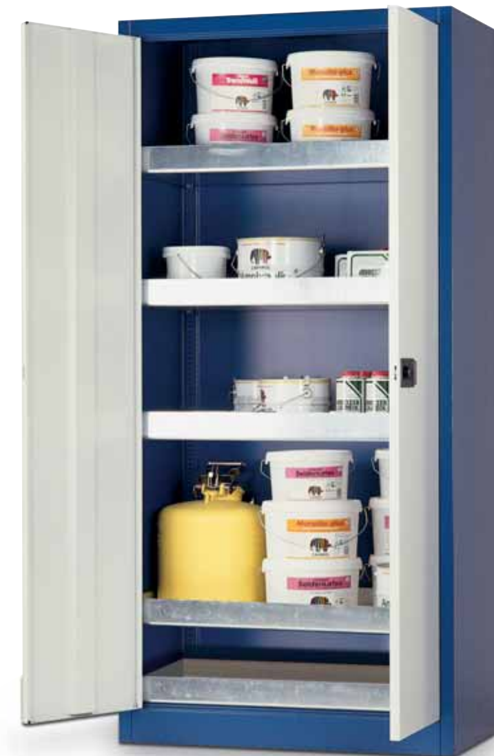
Foto: U.195.95 Armario para contaminantes del medio ambiente con cubeto inferior de recogida según STAWA-R y 4 cubetas zincadas.
